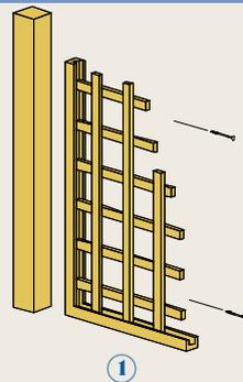
Fissaggio mediante viti mordenti
