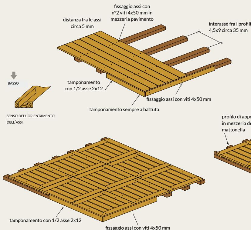
**Posa:** le mattonelle in legno vanno posizionate e avvitate ad una sottostruttura in legno impregnato in autoclave in classe 4 o materiale equivalente.
