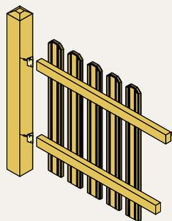
Fissaggio mediante ferramenta a "L"
