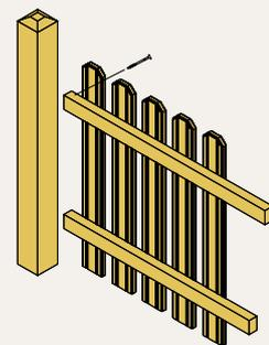
Fissaggio mediante viti mordenti
