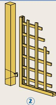
Fissaggio mediante ferramenta a "L"
