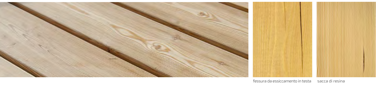
fessura da essiccamento in testa sacca di resina
